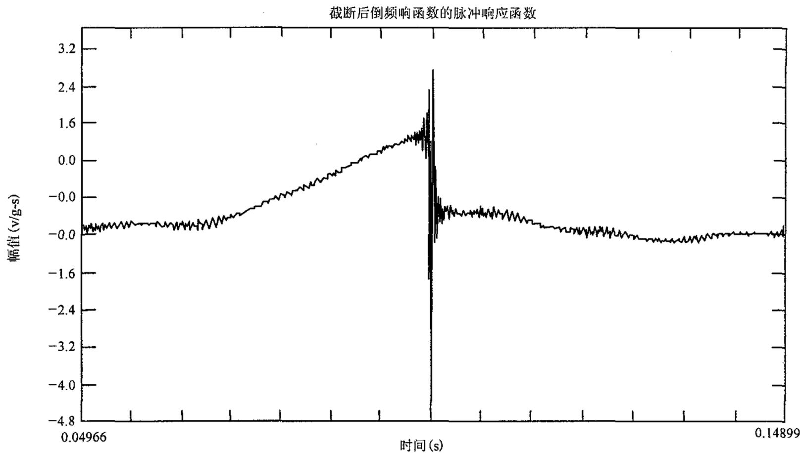
图 A. 5 脉冲响应函数
