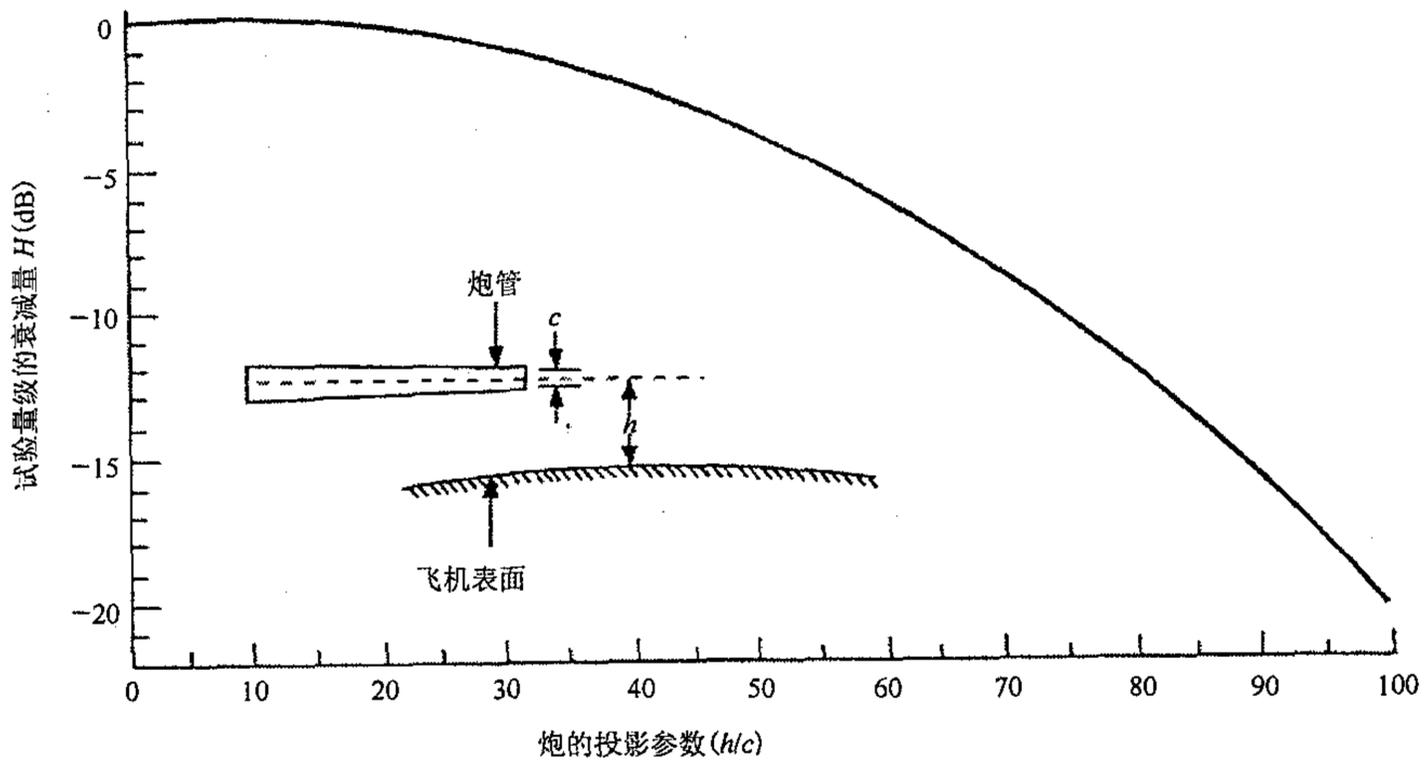
图 D. 4 由炮的投影参数导致试验量级的衰减量
